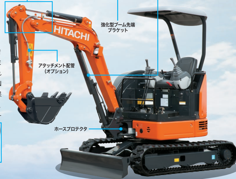
油圧ホースガード バケットホースをアームの内側に配置し、ホースを保護します。
