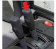
このスイッチは、積み込み作業のような、大きな駆動力が一時的に必要な場合に有効です。トラクションコントロールを「Auto」に設定している場合は、かき上げ状態を検知して自動的に駆動力がアップします。
