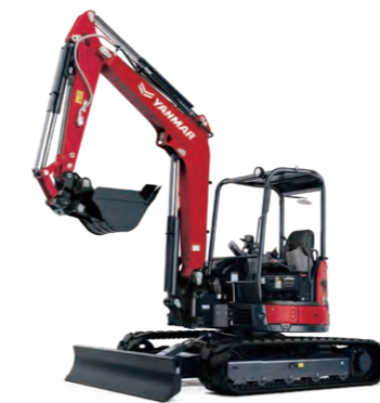
4柱キャノピー仕様(ROPS※1/FOPS※2基準)
