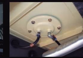
内部を清掃しやすくなった燃料タンク
