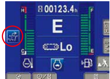
干渉自動回避システムをONにすると、モニター画面で干渉自動回避表示灯が青色点灯します
