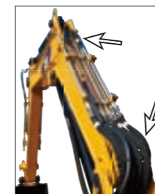
ブーム背面の油圧ホースの飛散防止用ファブリックカバー
