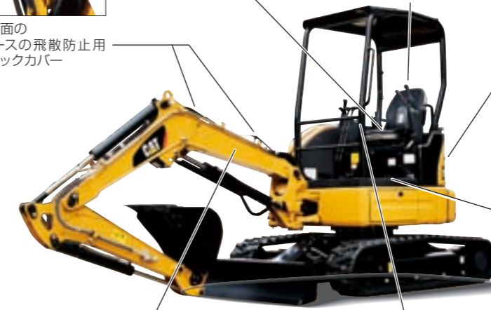
ブーム自然降下防止弁を装備。また、緊急時のブーム緊急降下スクリュウも採用
