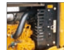
点検時の安全に配慮したエンジンファンガード
