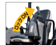
油圧ロックレバーを上げることで全作業機を油圧ロック可能
